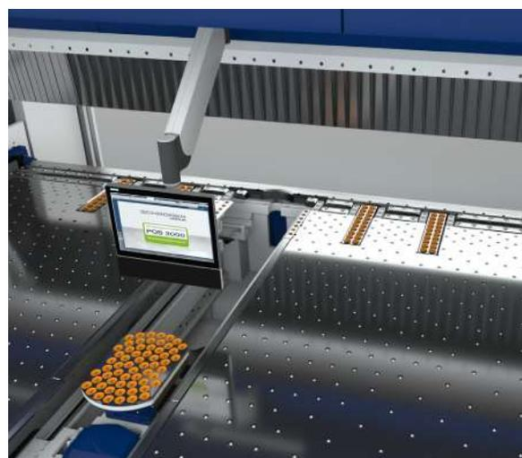
AHS Dispositivo di rotazione pezzo automatico: il pannello viene sollevato, ruotato e riposizionato automaticamente evitando di segnare il pezzo stesso.
