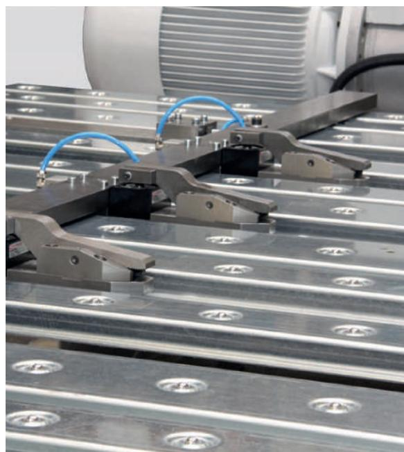
Pinze di presa per gestire l'avanzamento automatico della lamiera.
