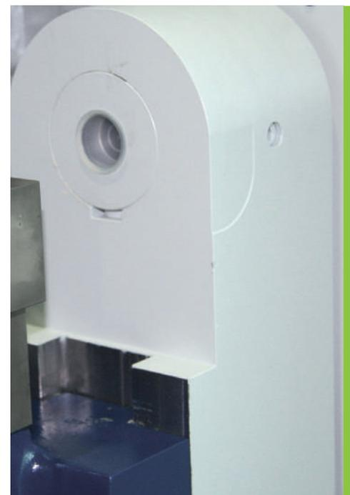
Particolare dell'asse controllato A, necessario per la regolazione del raggio di piegatura.
